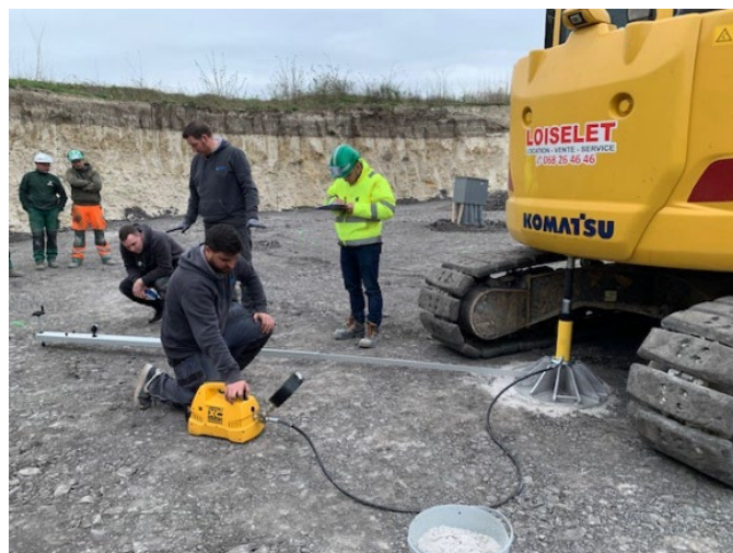
Mise au point de la mesure de déflexion à la poutre de Benkelman
