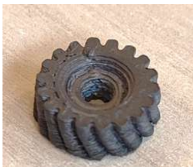
Pièce en WC-Co obtenue par impression PAM et frittés par technologie QuickSint : densité de la pièce > 99%, temps de frittage < 7 min.
