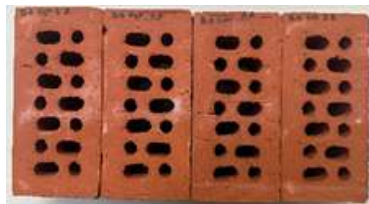
Photo briques après un cycle B24-209
