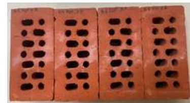
Photo briques après trois cycles B24-209
