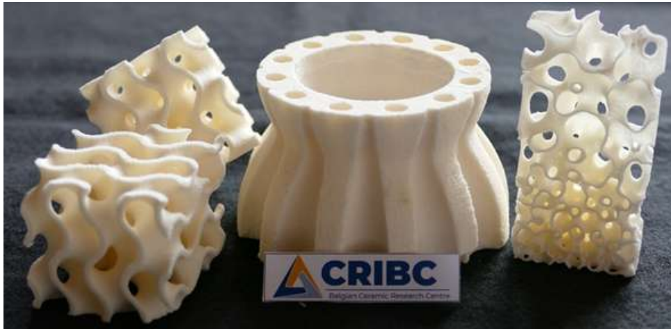
Exemple de scaffoldset d'objets en alumine fabriqués par Binder Jetting (projet Pôle Mecatech : ORBIT)
