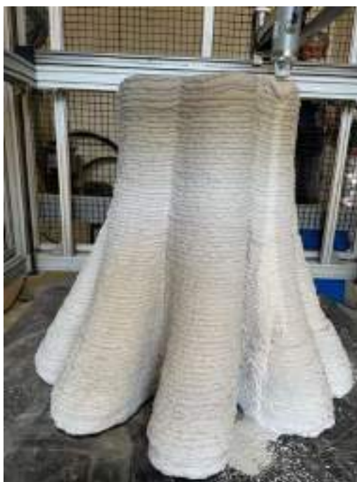
BEXTRUS – 3DFORMWORKS : impression de pièces préfabriquées de formes complexes en encre cimentaire réfractaire
