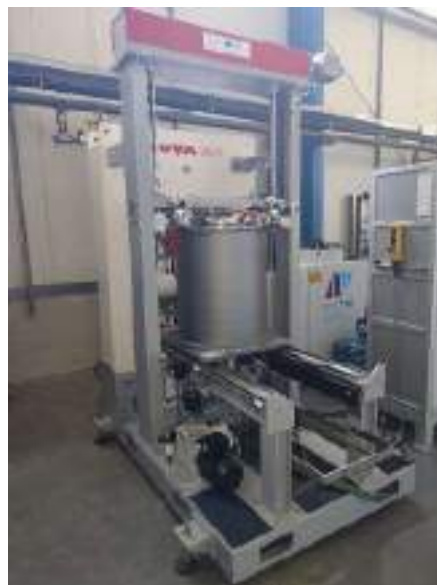
Nouvelle presse isostatique à chaud (four platine ; 1400°C ; 2000 bar)
