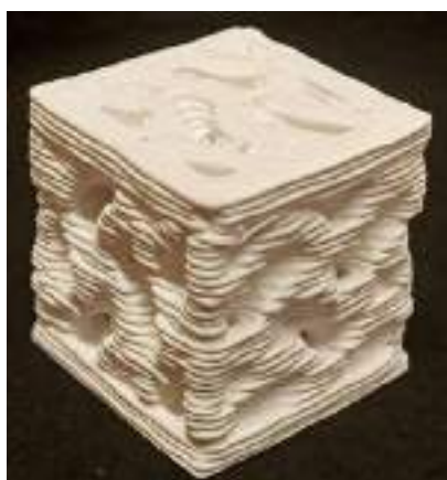
Exemple de scaffold architecturé fabriqué par le procédé additif de Robocasting – Direct Ink Writing Démonstration
