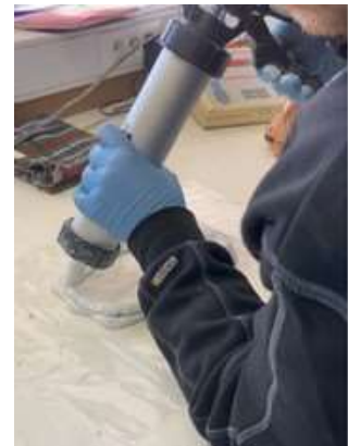
Test d'imprimabilité au pistolet de béton réfractaire imprimable par technologie 3D
