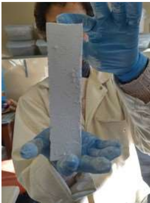
Echantillon de béton réfractaire sans ciment
