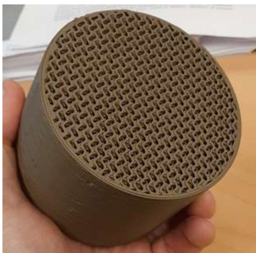
Exemple de scaffold architecturé fabriqué par le procédé additif de Pellet Additive Manufacturing
